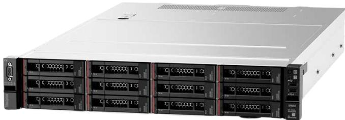
Поддерживает установку до 2-х процессоров и выполнен в стоечном исполнении высотой 2U для размещения в стандартных телекоммуникационных стойках. Конструкция платформы обеспечивает масштабируемость вычислительных ресурсов, гибкость конфигурации подсистемы хранения данных и расширение интерфейсов ввода-вывода в зависимости от требований к нагрузке.
